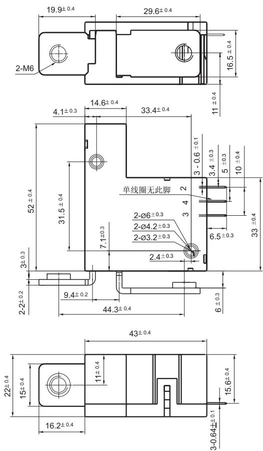
D型触点引出-取样电阻典型示例图
